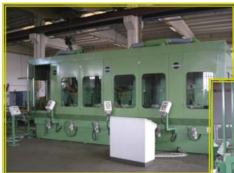
МОД. SF 3000/200/6U с 6 шлифовальными станциями. Система транспортировки заготовок: V-образные направляющие.
