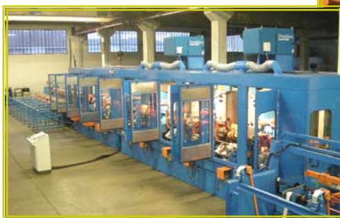
МОД. SF 3000/200/6U + CP 500/3U-200 с 6 шлифовальными и 3 полировальными станциями.
